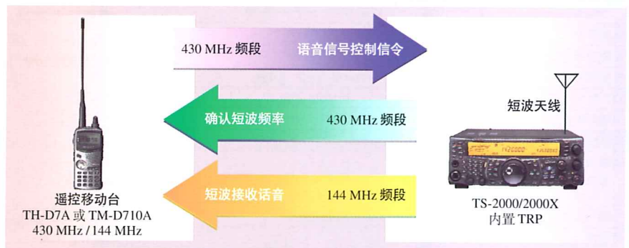
移动台完全遥控 TS-2000 电台操作图
